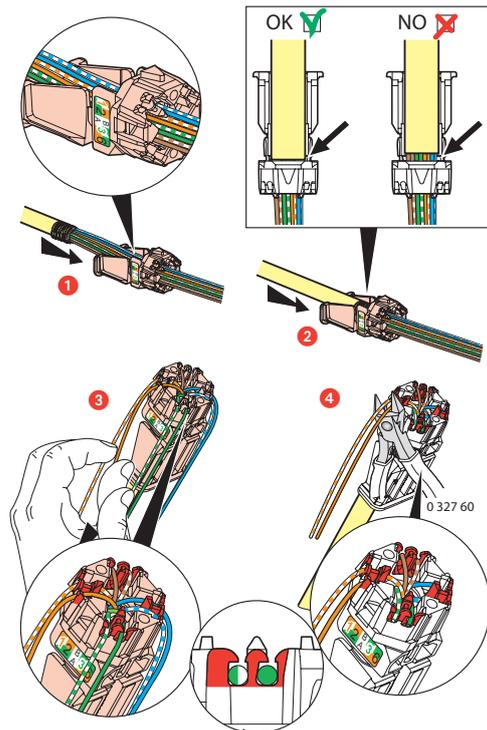
L'épanouissement de câbles et la mise en butée de la gaine dans l'épanouisseur permettent de garantir un respect de 13 mm de dépairage de chaque paire tel que demandé par la norme.
